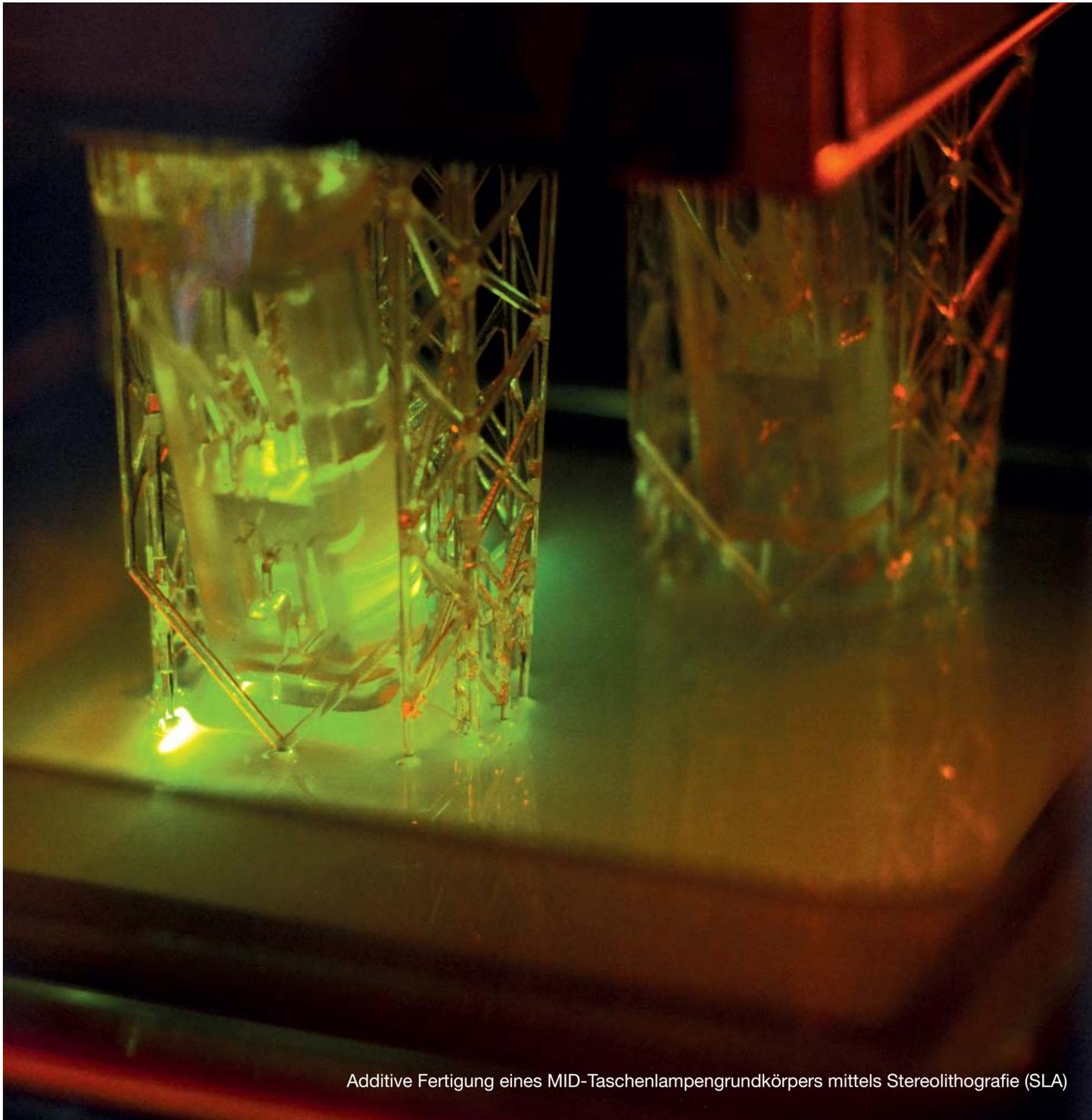
Additive Fertigung eines MID-Taschenlampengrundkörpers mittels Stereolithografie (SLA)
