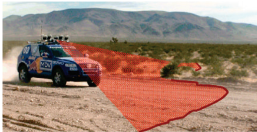
Bild 4: Das autonome Fahrzeug Stanley gewann die DARPA Grand Challenge 2005. Auf dem Fahrzeug sind eine Vielzahl von Laserscannern angebracht. Der rot dargestellte Bereich zeigt die Hinderniserfassung auf Basis geometrischer Beziehungen [57].
