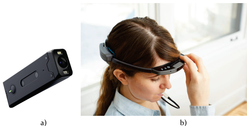
Bild 8: Assistenzsysteme zur Unterstützung der Umgebungserfassung bei Sehbeeinträchtigungen. a) OrCam MyEye 2.0 Ergänzung für Brillen mit integrierter Objekterkennung [155]. b) Wicab Brainport Vision Pro zur Erfassung von Umrissen der Umgebung und elektro-taktile Übermittlung mittel Elektrodenarray für die Zunge [157].
