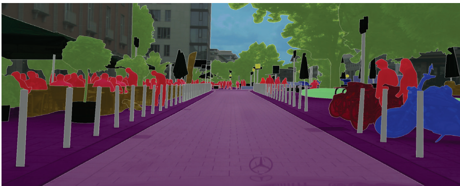
Bild 3: Beispielbild aus dem Cityscape Datensatz zur semantischen Segmentierung von Kameraaufnahmen von Straßen. Die Farben charakterisieren dabei die jeweiligen Klassen (z. B. Personen, Fahrbahn) [50, 54].
