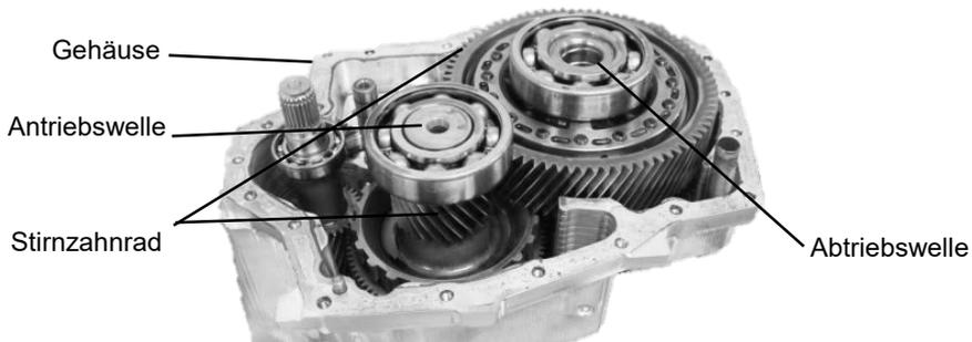
Bild 17: Einstufiges Getriebe in elektrischem Achsmodul [193]
