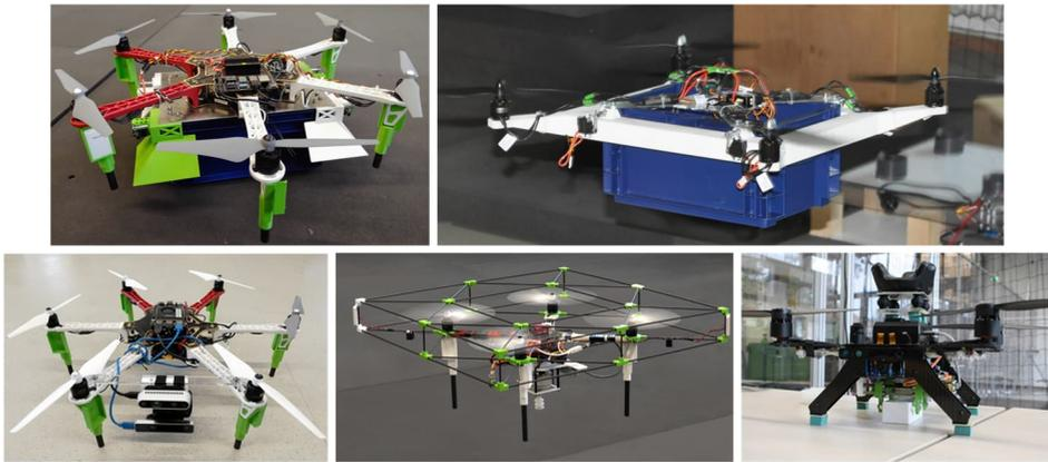
Bild 41: Auswahl der zur Evaluation der erforschten Methoden entwickelten und eingesetzten AFR. Dargestellt sind auf den Warentransport und die Objektinteraktion spezialisierte AFR sowie AFR zur optischen Informationserfassung [P5, P11, S6, S47]
