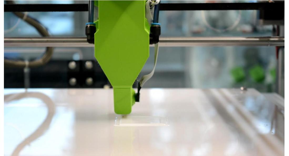
Durch den Druck von Silikonstrukturen und rGO-Tinten mittels Aerosol-Jet-Druck werden dielektrischen Elastomeraktoren, sogenannte künstliche Muskeln, realisiert.
