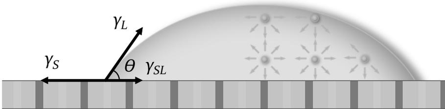
Bild 17: Flüssigkeitstropfen auf einem Verbundwerkstoff mit idealer Oberfläche, dargestellt mit intermolekularen Kräften, den Oberflächenspannungen nach Young und dem resultierenden Kontaktwinkel
