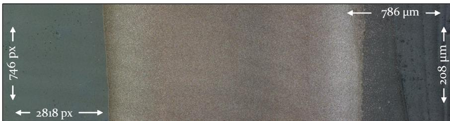
Bild 33: Zusammengesetzte Mikroskopaufnahme einer gedruckten Leiterbahn mit einer Auflösung von 2818 x 746 Pixel und einem Messausschnitt von 786 µm x 208 µm
