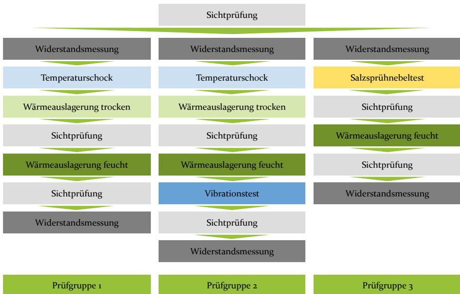
Bild 26: Teilprüfsequenz für Steckverbinder der Automobilbranche [89]
