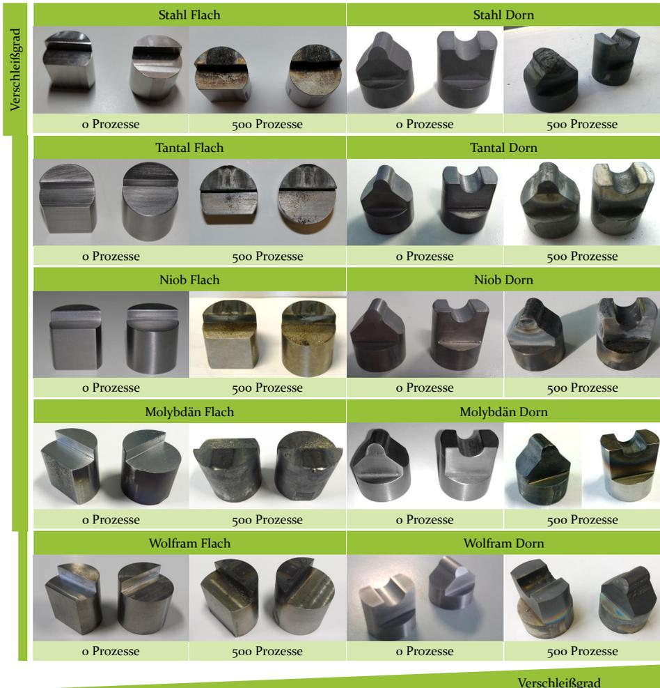
Bild 51: Abgleich des Verschleißes variierender Heißcrimpelektroden [S14,S15,S16,S17,S18]
