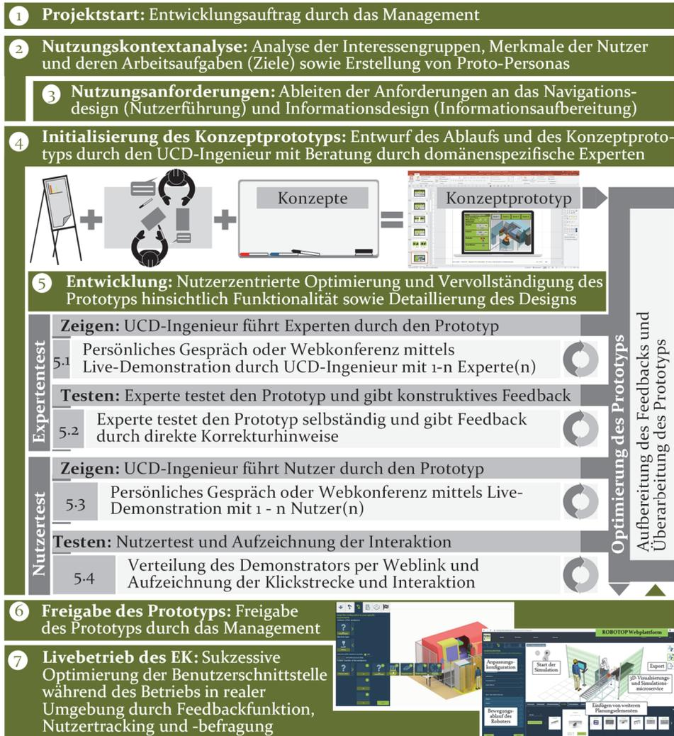
Bild 73: Methode zur Entwicklung von Benutzerschnittstellen für EK mittels agiler Prototypenentwicklung und Optimierung
