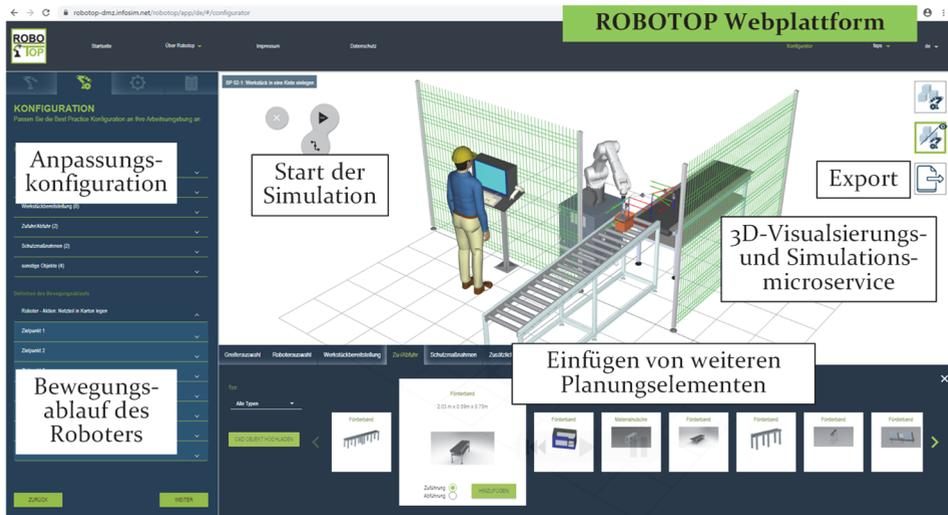
Bild 68: Prototyp der ROBOTOP Webplattform, Anpassungskonfiguration mit 3D-Visualisierung und Simulation der BP-Szene (Phase 2 - Individualisierung)
