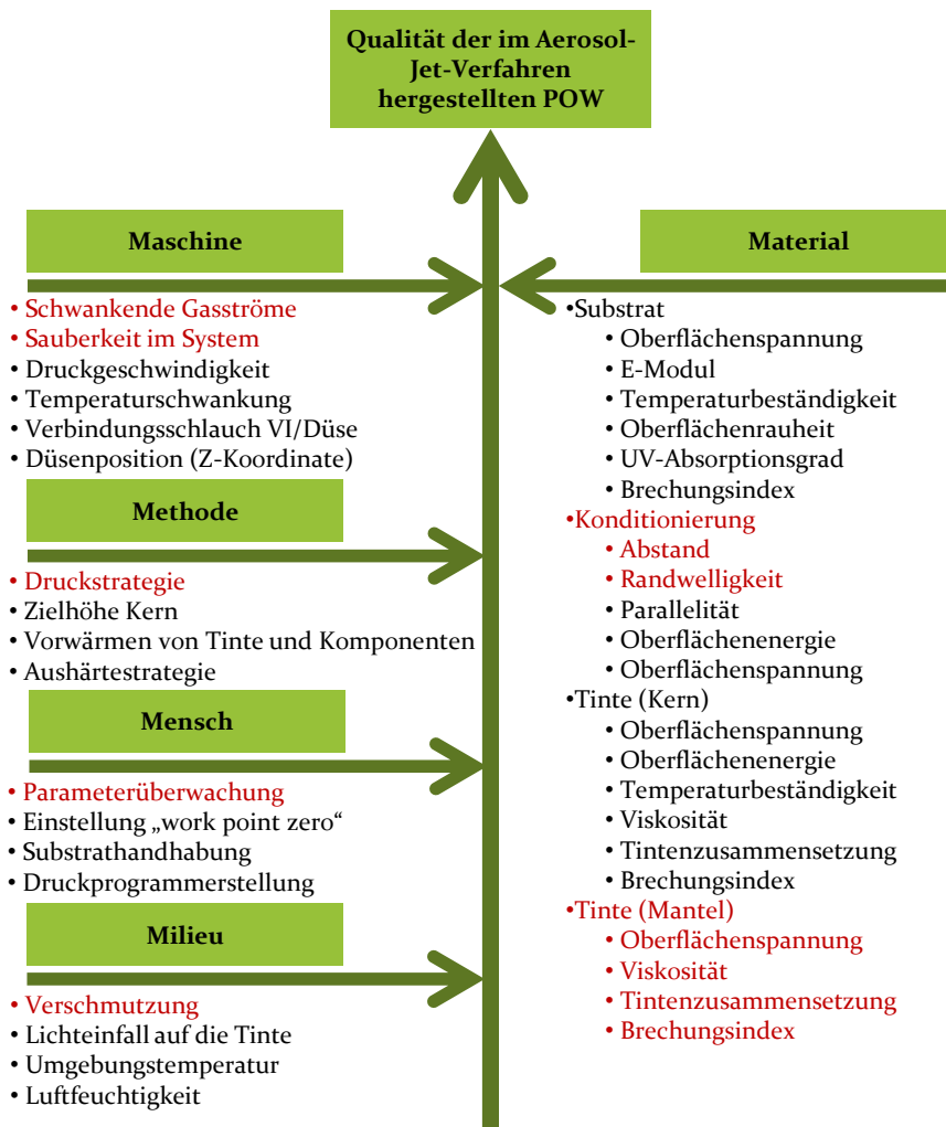
Bild 28: 5-M-Analyse der prozessrelevanten Einflussgrößen auf die Qualität gedruckter POW.
