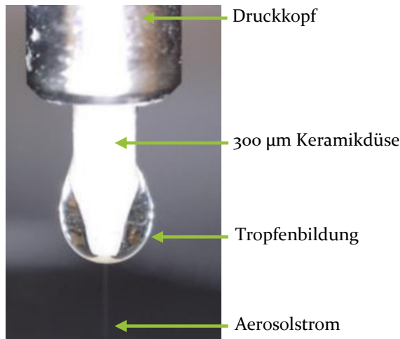
Bild 29: Tropfenbildung an der Düsenspitze.
