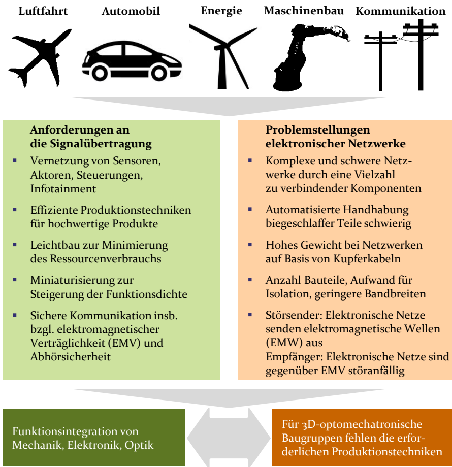
Bild 1: Gegenüberstellung der Anforderungen an die Signalübertragung und den vorhandenen Problemstellungen elektronischer Netzwerke für den industriellen Einsatz.
