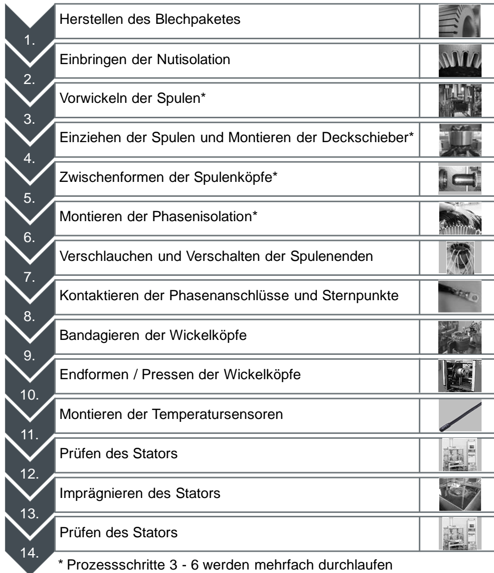
Abbildung 3.14: Prozessablauf zur Herstellung einer verteilten Wicklung mittels Einziehtechnologie 12
