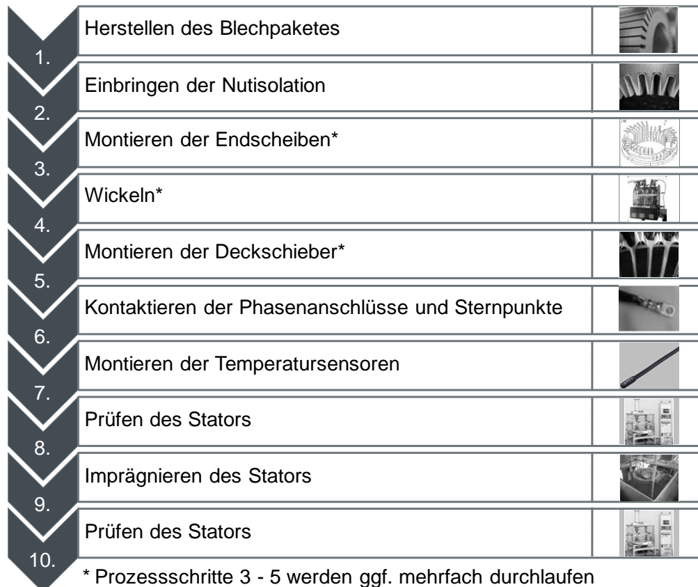
Abbildung 3.16: Prozessablauf zur Herstellung einer verteilten Wicklung mittels Nadelwickeltechnologie 13
