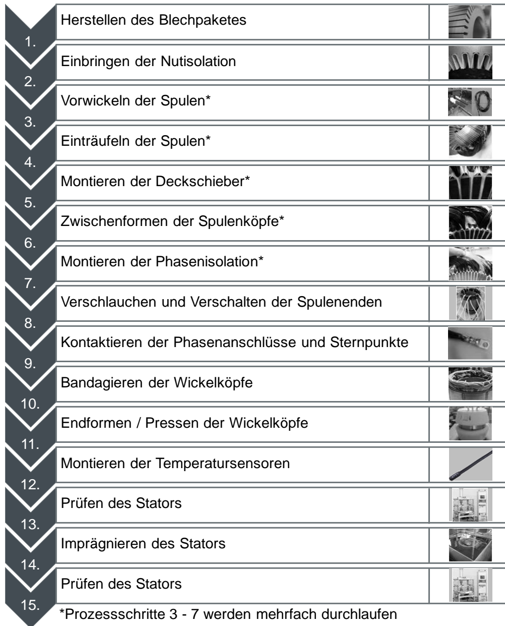
Abbildung 3.11: Prozessablauf zur Herstellung einer verteilten Wicklung mittels Träufeltechnologie 9
