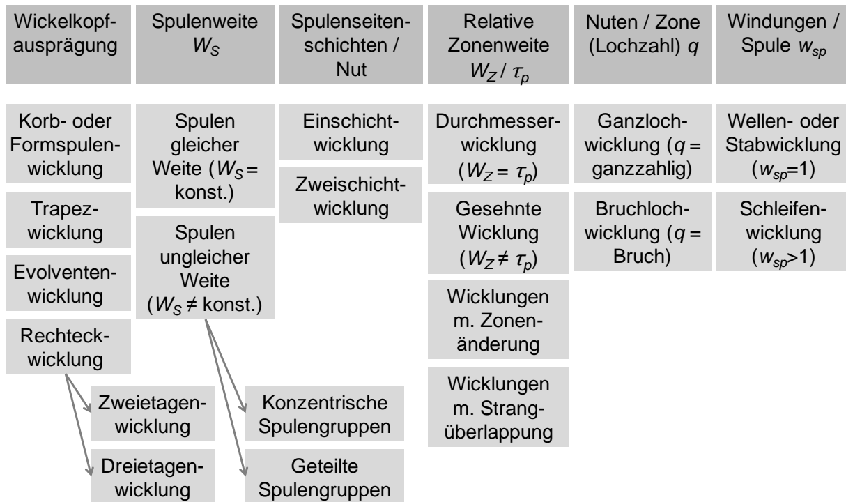
Abbildung 2.14: Einteilung der Drehstromwicklungen, angelehnt an [28, 53]
