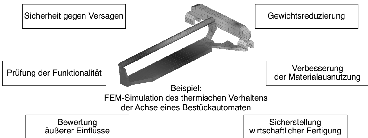
Abb. 7 Ziele numerischer Simulationsverfahren bei der Bauteilgestaltung
