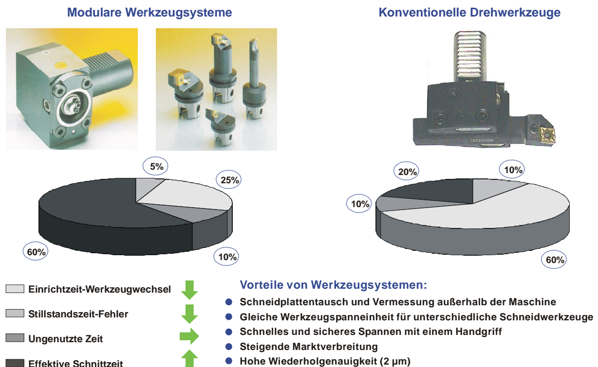
Bild 16: Vergleich der Maschinenzeiten für verschiedene Spannsysteme [81]
