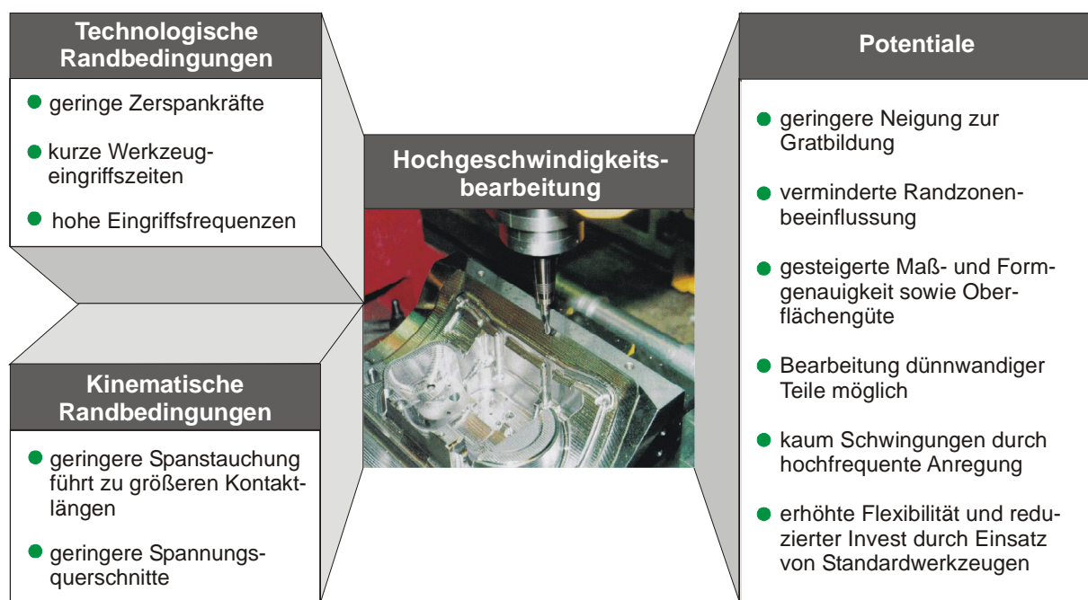
Bild 11: Randbedingungen und Potenziale der Hochgeschwindigkeitsbearbeitung [130]
