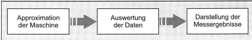
Bild 61: Vorgehensweise bei der experimentellen Modalanalyse
