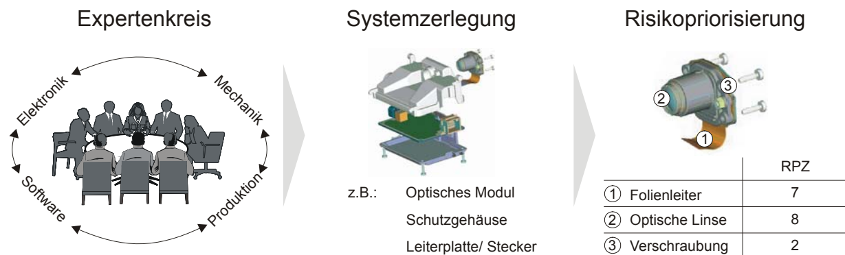
Bild 19: Vorgehen zur Identifikation kritischer Systembestandteile am Beispiel eines komplexen mechatronischen Systems
