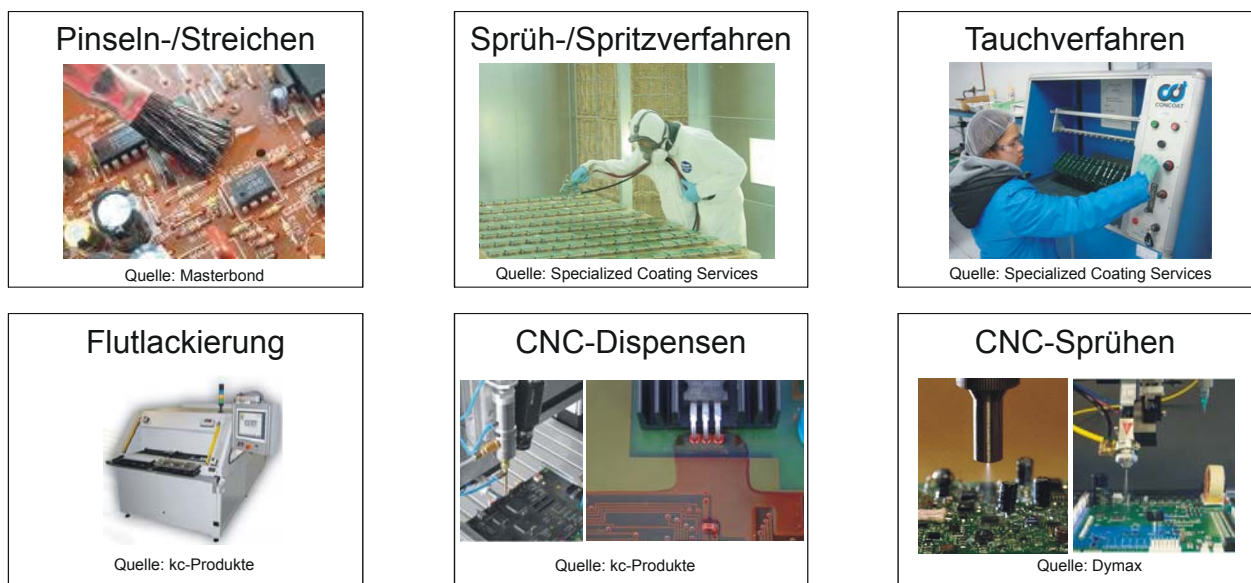
Bild 57: Manuelle und maschinelle Verfahren zum Lackauftrag
