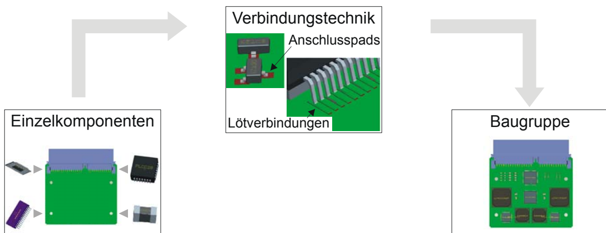
Bild 88: Modellgenerierung aus Einzelkomponenten sowie Aufbau- und Verbindungstechnik
