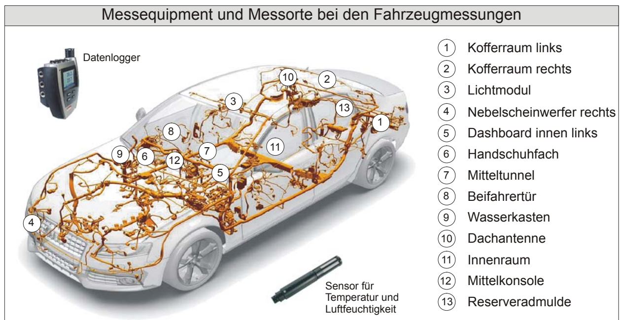
Bild 75: Messorte zur Bestimmung mikroklimatischer Anforderungen im Automobil sowie das dabei verwendete Messequipment
