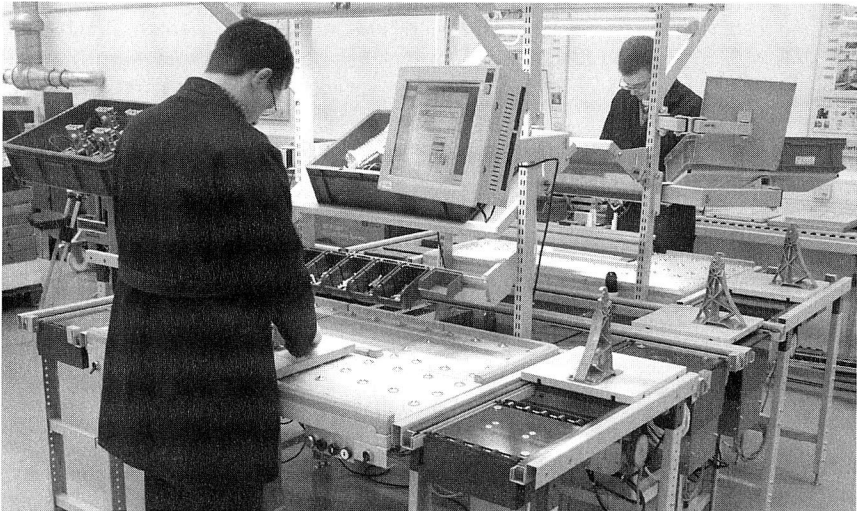
Bild 73: Manueller Arbeitsplatz mit Panel-PC zur Nutzung eines Mitarbeiterinformationssystems
