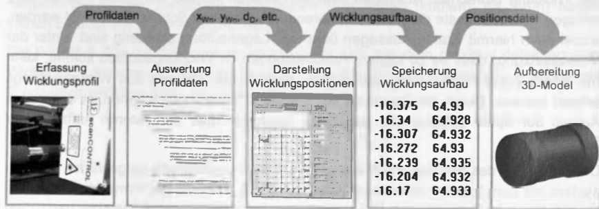
Bild 47: Ablauf der Wicklungserkennung mittels Laser-Profilscanner
