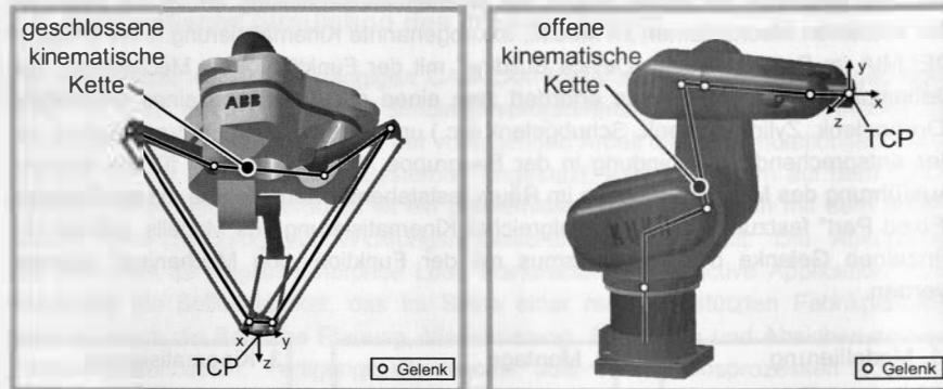
Bild 107: Prinzipieller Aufbau einer geschlossenen kinematischen Kette (links) und einer offenen kinematischen Kette (rechts)
