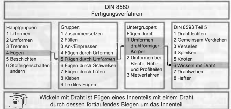
Bild 4: Das Fertigungsverfahren Wickeln in der DIN 8593 Teil 5 [119] als Untergruppe der DIN 8580 [118]
