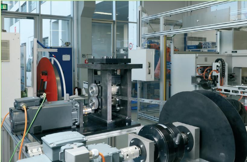
Abb. 3: Prototypische Anlage zum Rotationsschneiden von Elektroband als ergänzende Alternative zum konventionellen Stanzen ■
