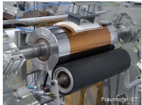
Anlage für das Rolle-zu-Rolle Plasmaprinting
