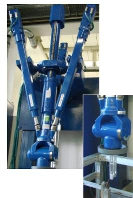
Alternative robotergestützte Wickelsysteme am E|Drive-Center
