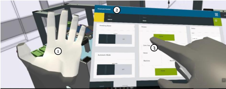
Bild 36: Virtuelle Nutzerinteraktion mit einem, durch Gestenerkennung der HE (1) dynamisch platzierten Touch Panels (2) durch simulierte Berührung (3) in Anlehnung an [P15]
