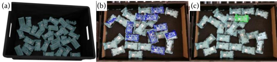
Bild 62: Einsatz einer synthetisch trainierten Poseschätzungspipeline auf reale Daten am Beispiel des Deckels. (a) Exemplarisches synthetisches Trainingsbild mit bekannter Annotation. (b) Hypothesen des SSP auf realer RGB-Aufnahme. (c) Verfeinerte Hypothese des zu greifenden Teils
