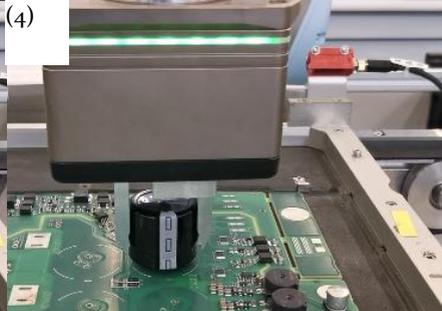
Bild 53: OLP eines THD-Montageprozesses anhand eines mittels 3D-Scan kalibrierten Simulationsmodells. (a) Kombinierte Simulationsszene mit virtuellen Komponenten und digitalisiertem Montagesystem. (b) Programmausführung: (1) Initialanfahrt mit sichtbarem Versatz; (2) Erzielte Endposition der Suche  $S_1$ ; (3) Zweiter Programmdurchlauf mit optimierter Startposition; (4) Direktes Einführen ohne Suche
