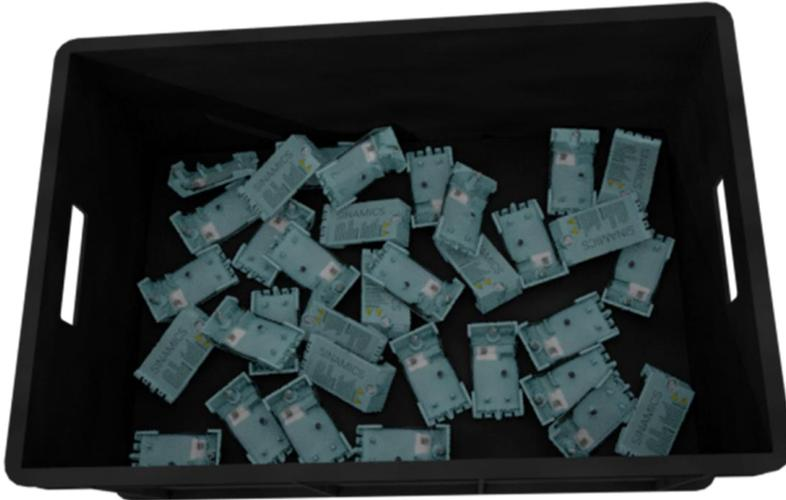
Bild 28: Synthetisch generierte Ansicht einer zufällig gefüllten Kiste mit bekannter 6D-Pose
