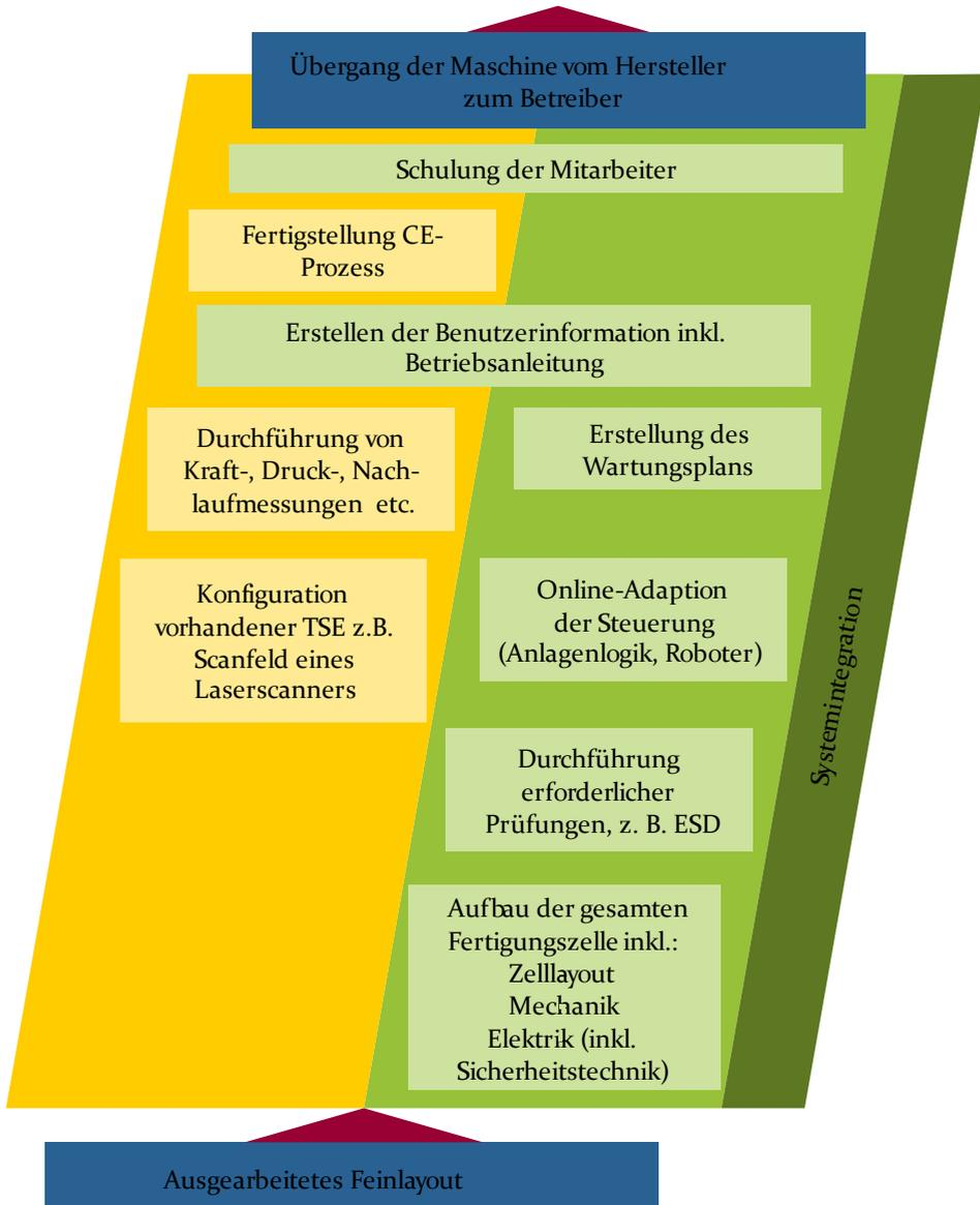
Bild 41: Systemintegrationsphase eines hybriden Montagesystems unter Abschluss des herstellerseitigen CE-Prozesses in Anlehnung an [S4]
