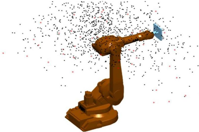
*Abbildung 25: Messpositionen im Roboterarbeitsraum bei einer geometrischen Kalibrierung [106]*
