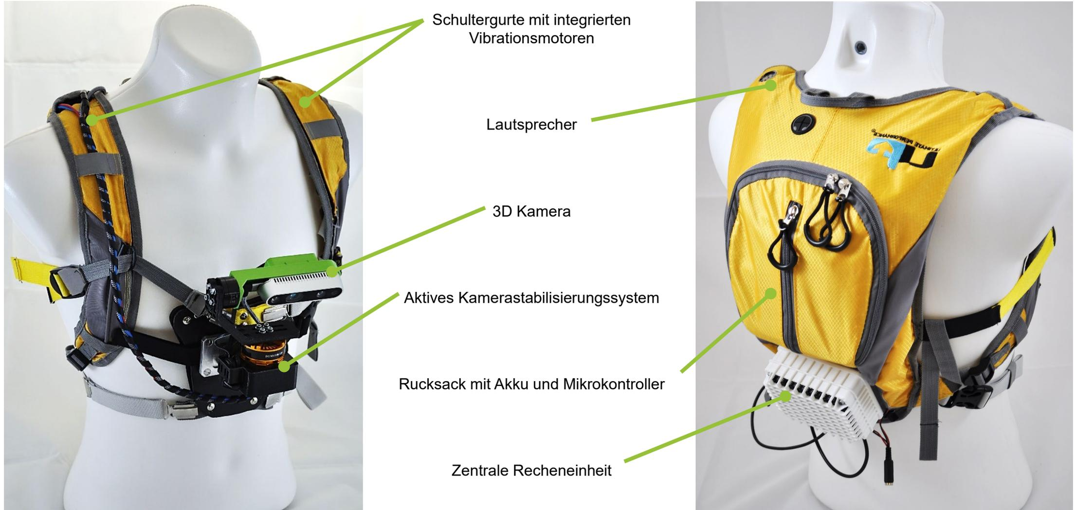
Ein tragbares Assistenzsystem ermöglicht die Navigation blinder Jogger durch Umgebungserfassung mit Hilfe einer 3D Stereo Kamera.
